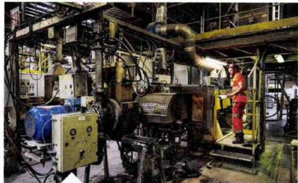
Près d'une extrudeuse, un opérateur change les filtres encore fumants.
