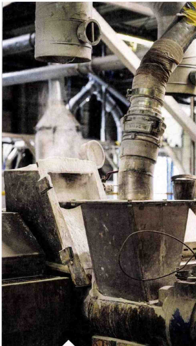
La ligne d'extrusion comprend un tunnel chauffant équipé d'une vis pour ramollir la matière, puis la découper et la refroidir avant de sortir des granulés.
